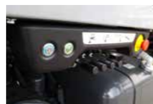
COMANDI STABILIZZAZIONE IDRAULICI Comandi per stabilizzare la pompa su entrambi i lati della macchina. Anche il fungo di emergenza è posizionato nella stessa zona.
