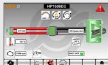
GESTIONE GRUPPO POMPANTE Il sistema gestisce autonomamente il gruppo pompante, pressione e velocità del motore al fine di ottimizzare le prestazioni.
